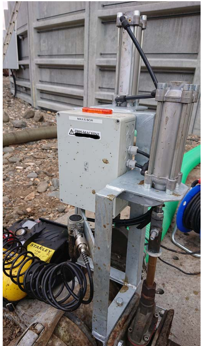
Mynd 4. Heimasmíðaður loftknúinn lokubúnaður. Búnaðurinn er virkjaður með fjarstýringu innan úr dráttarvél svo aldrei þurfi að stíga út. Þegar áfyllingu er lokið, lokast fyrir lokann út í tank en þá opnast fyrir loka ofan í þró sem tekur affalið úr trektinni.
