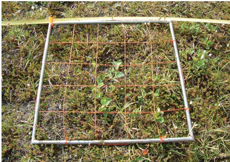
Mynd 2.7. Mælingarammi 0,5 x 0,5m af þeirri gerð sem notuð var við Hálslón. Böndin marka 10 x 10 reiti. Ramminn er í mólendi við Lindur, myndin er tekin 2003.
