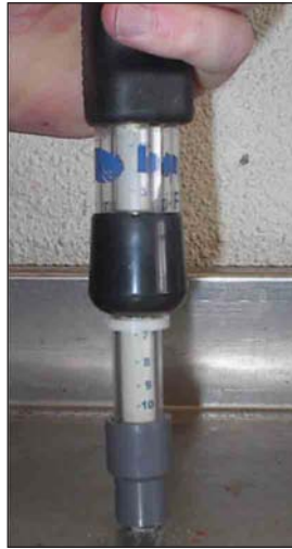
Sérhæft tæki til mælingar á brotstyrk áburðarkorna. Mynd Haukur Þ.
