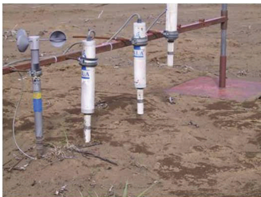
3. mynd. Fokstautar staðsettir í þremur hæðum á Hólsfjöllum 2002. Virka efnið eru málmþjöttur neðarlega á stautunum.
