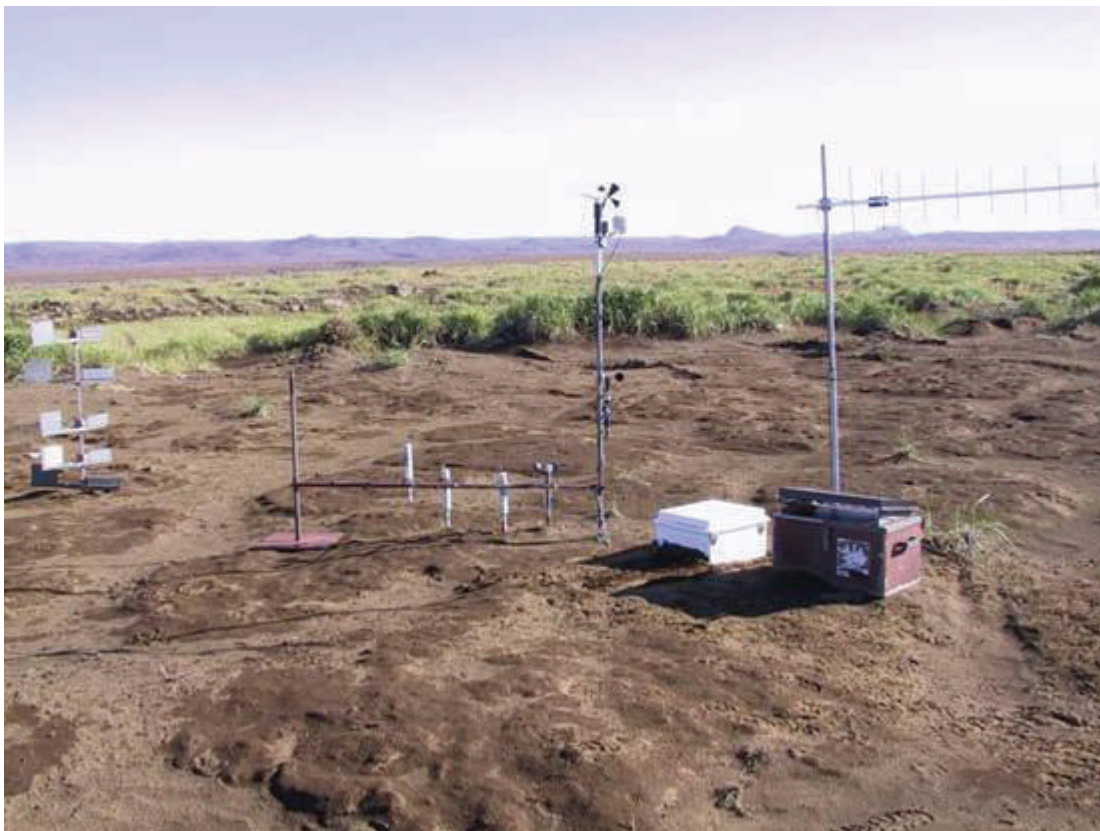
5. mynd. Mælitækin á Hólsfjöllum. Lengst til vinstri eru 5 gripgildir en fyrir miðju eru þrjú fokstautar. Vindhraði er mældur í skálum í þremur hæðum en sá efsti ( 2 m hæð) mælir einnig vindátt. Þá er hiti mældur á 2 m hæð og í 60 cm hæð sem og rakastig í 2 m hæð og jarðvegshiti á 5 cm dýpi. Gögnum er safnað í gagnastokk í hvíta kassanum og nálgast mátti gögnin með símasambandi (loftnet).
