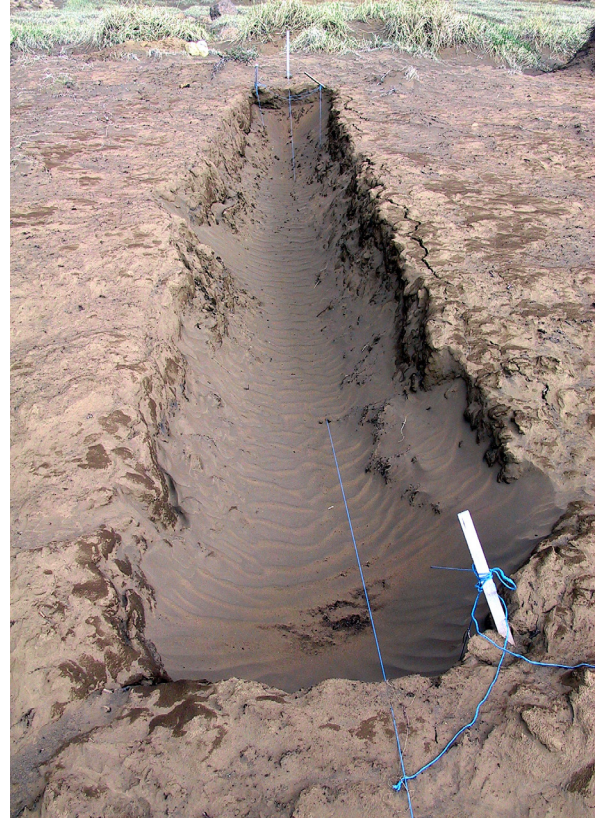
12. mynd. Skurðurinn hálf fullur, 10 júní 2003. Ætla má flæði nemi um >600 \text{ kg m}^{-1} síðan skurðurinn var grafinn miðað við rúmþyngdina 1 \text{ t m}^{-3} .
