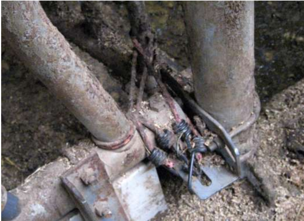
Jafn einfalt og það lítur út fyrir að vera. Teygur binda saman hliðið neðanvert og þvergrind og þegar læsingin opnast toga teygjurnar í hliðið og það opnast!
