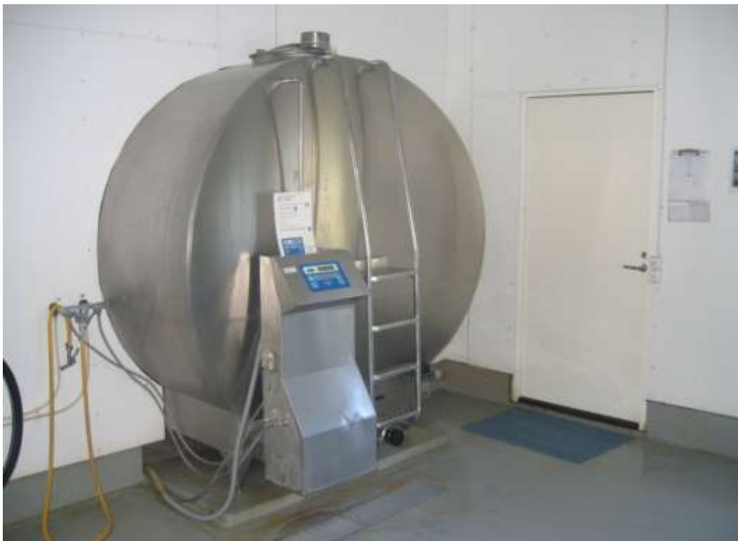
Mjólkurhús þarf ekki að rúma heilan mjólkurtank, eingöngu enda hans. Hér er mynd úr erlendu fjósi þar sem hinn endi tanksins stendur í óeinangruðu rými.
