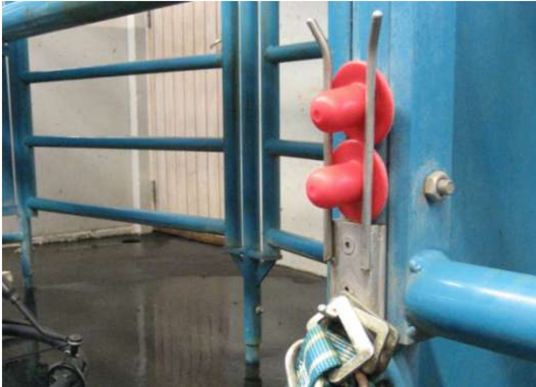
Hér má sjá einfalda en góða lausn á tappageymslu m.m. í mjaltabás. Með slíka „einingu“ við hvert mjaltatæki er alltaf auðvelt og fljótlegt að bregðast við.
