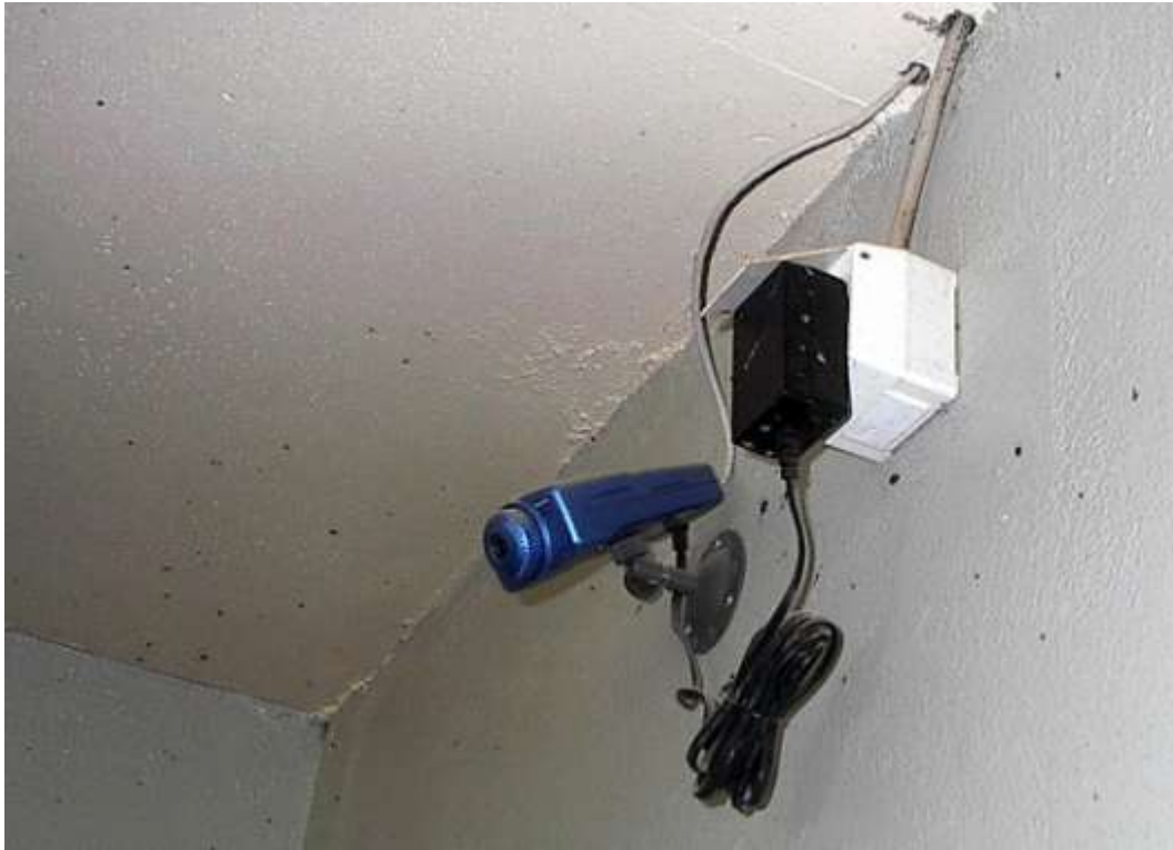
Hér má sjá einföldustu útgáfu efirlitsmyndavélar, venjuleg vefmyndavél sem er tengd með netsnúru við vefinn og hægt að skoða myndir úr henni hvar sem er, komist viðkomandi inn á netið.
