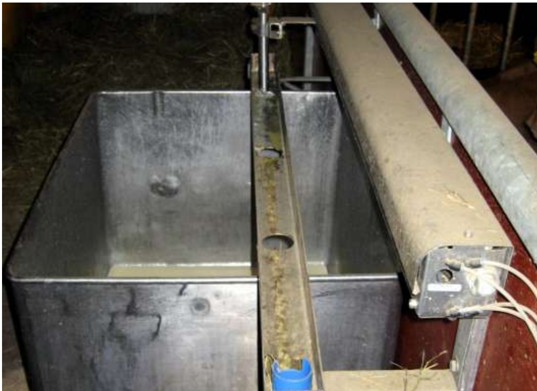
Frá mjaltahjónum kemur mjólkinn í þar til gerða sprautu sem getur fyllt á mismunandi mjólkurkúta. Oft skapast nokkur sóðaskapur af „slefi“ úr þessari sprautu en á þessum bæ hafði verið búin til fin renna sem tók við þessu.
