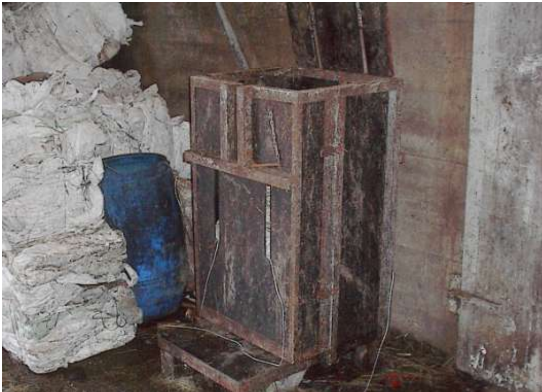
Rúllubaggplast er víða til vandræða en hér hafði bóndinn smíðað sér litla plastpressu sem var svo með opnanlegri framhlið.
