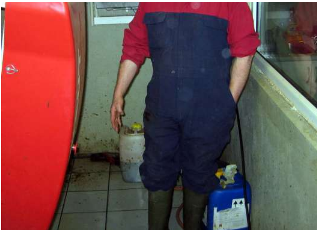
Oft eru þrengsli töluverð armmegin við mjaltapjóna, hér má sjá allt of lítið pláss en armurinn er í vinnustöðu þegar myndin er tekin og á því eftir að ganga töluvert til baka.
