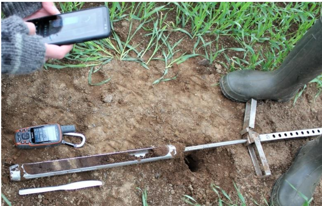
Mynd 22. Þessi sýnatökubor var notaður við leit að gjóskulögum og reyndist vel. Hann náði sýnum í allt að 1,2 metra dýpt.
