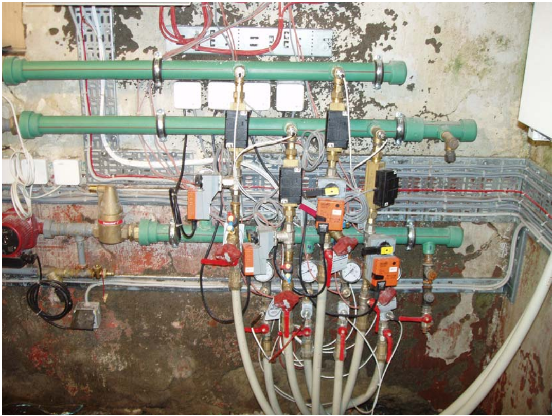
14. mynd. Lagnagrind fyrir tilraunina.
